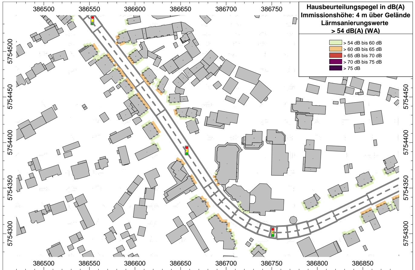
Abb. 11.2.21 Beurteilungspegel ab 54 dB(A) unter Berücksichtigung der derzeitigen Geschwindigkeiten nachts im Bereich der Daruper Straße und Potthof mit Tempo 50 gemäß RLS-19
